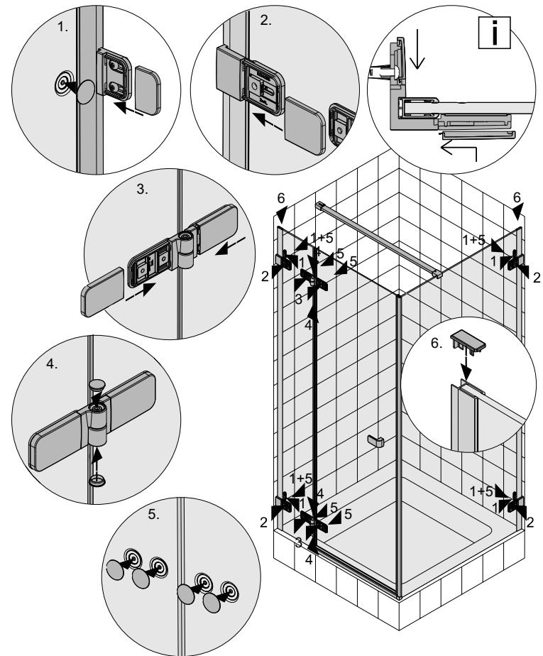
**RO** Fixați elementele de acoperire a suruburilor de instalare a consolelor de sușinere a ușii fixe și peretelui pe suprafața interioară și cea exterioară a cabinei de duș. Apoi, fixați elementele de acoperire a suruburilor de instalare a balamalelor ușilor.
