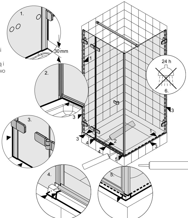
**RUS** С внутренней стороны кабины уплотните санитарным силиконом соединения нижних краев стеки двери, неподвижной стенки и нижнего профиля с поддоном. С внешней стороны кабины уплотните соединения боковых и нижних краев кабины со стеной и поддоном, а также нижнего профиля с поддоном. Дополнительно уплотните соединение нижнего профиля соединителями. После завершения монтажа кабиной нельзя пользоваться на протяжение 24 часов. Это время нужно для соответствующего затвердения силикона.
