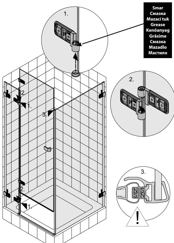
**PL** Nałóż dolną zaślepke zawiasu i nasmaruj wewnętrzne części zawiasów przykręconych do elementu stałego drzwi, a następnie zamocuj drzwi łącząc ze sobą elementy zawiasów. Upewnij się, że magnesy w uszczelkach (drzwiowej i ścianki) łączą się ze sobą.
