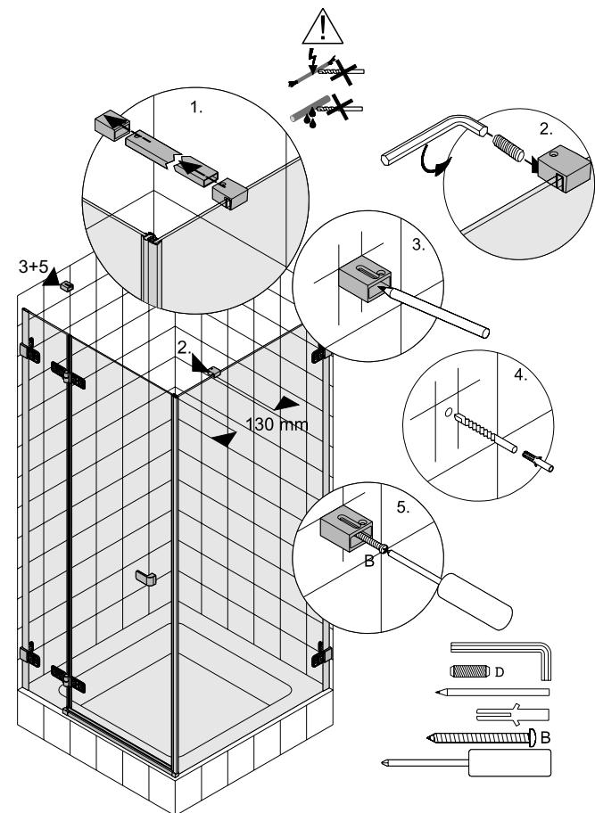
**RUS** Снимите опору, отделяя профиль от элементов крепления. Прикрутите элемент крепления опоры к стенке и кабине. Потом приложите настенный элемент крепления опоры к стене и отметьте место сверления монтажного отверстия. Высверлите в стене отверстие, диаметром 6 мм, вставьте в него распорную пробку, а потом прикрепите настенный элемент крепления опоры шурупом В.
