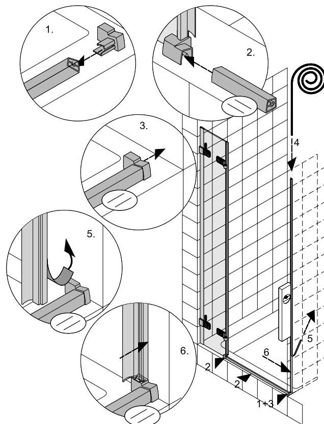
**PL** W profil dolny wsuń plastikowy łącznik przyścienny i umieść go w łączniku założonym na elemencie stałym drzwi. Następnie dosuń profil dolny do ściany we wnęce. Wsuń w uszczelkę przyścienną pasek magnetyczny, przystaw ją do ściany i wypoziomuj. Następnie zdejmij pasek osłaniający warstwę kleju i przyklej uszczelkę do ściany.
