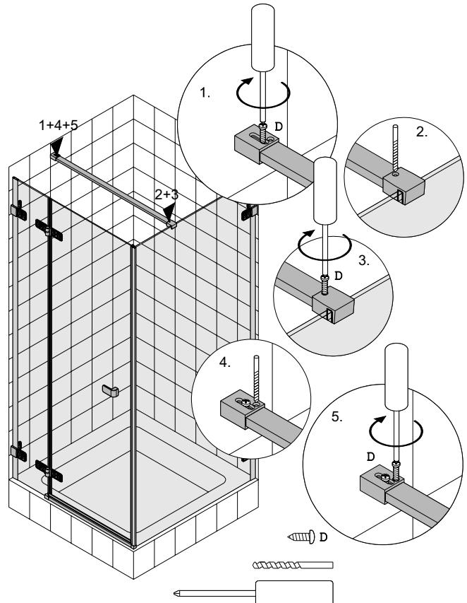
**SK** Upevnite profil ramena v montážnych prvkoch a za pomocí skrutiek D zablokujte profil v montážnom prvku na stene. V mieste otvorov montážnych prvkov, vyvŕťte otvory do profilu ramena a potom ho priskrutkujte skrutkami D.
