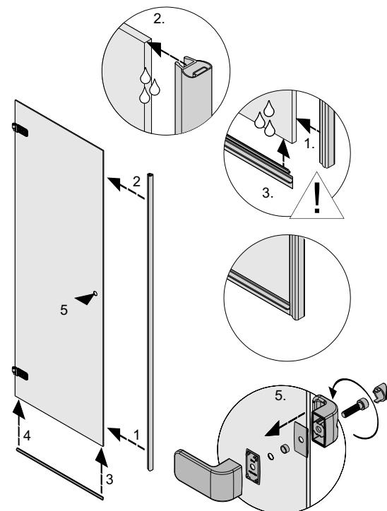
**SK** Nasadte magnetickú tesiacu lištu na dvere. Predtím navlhčite okraj skla mydlovým roztokom, montáž magnetickej tesniacej lišty sa tým zjednoduší. Spodnú tesiacu lištu nasadte na dolný okraj dverí a zarovnajte ju s magnetickou tesniacou lištou. Pripevnite na dvere držadlo.
