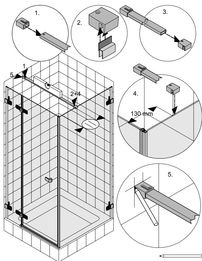
**SK** Na profil ramena (pripevňujúceho pevnú bočnú stenu k protiľahlej stene) nasuňte montážny prvek pre upevnenie k stene. Do montážného prvku pre upevnenie na pevnú bočnú stenu vložte ochrannú podložku a potom tento prvek nasadte na rameno. Rameno nasadte na pevnú bočnú stenu vo vzdialenosť 130 mm od okraja dverí a vyrovnajte ju. Označte miesto montáže ramena na protiľahlej stene.
