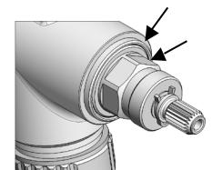
Nasad'te zadní část rukojeti **A** a našroubujte a dotáhněte pouzdro **B** (utahovací moment 10-15 Nm), zadní část rukojeti **A** by se měla volně otáčet, aniž by byla příliš velká vůle (max. 0,3 mm) v axiálním směru
