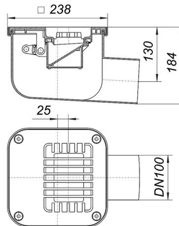
mit Automatik-Klappe als Rückflusssicherung und sperrwasserlosem Geruchsverschluss
